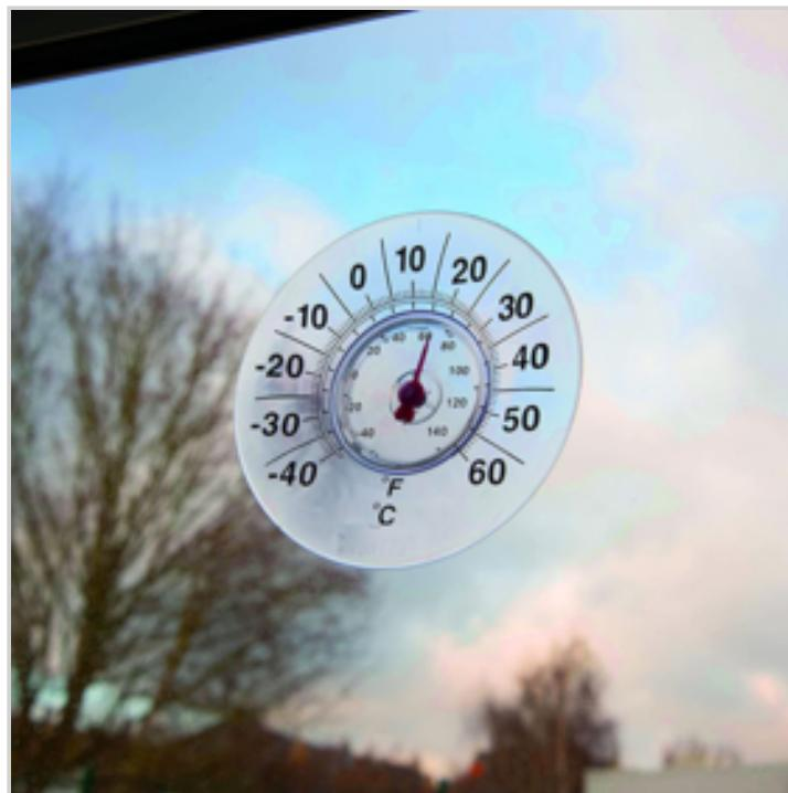
Ce thermomètre à ventouse se fixe à l'extérieur d'une vitre : la température sera ainsi lisible de l'intérieur.
